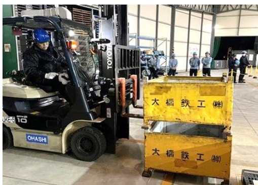
前後左右の距離感が重要な鉄パレットの荷役操作
